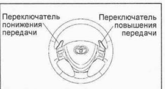
При нажатии правого переключателя происходит повышение на одну передачу, при нажатии левого переключателя происходит понижение на одну передачу.
