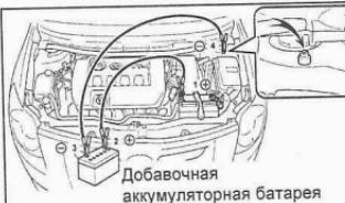
**Примечание:** во избежание серьезной травмы при выполнении соединений не наклоняйтесь над аккумуляторной батареей и не допускайте случайного прикосновения кабелей или зажимов к чему-либо, кроме соответствующих полюсов аккумуляторной батареи или массы.
