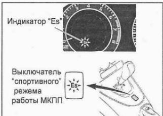
При запуске двигателя "спортивный" режим автоматически отключается.
