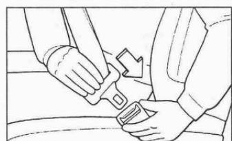
Слегка вытяните ремень для регулирования желаемого натяжения.
